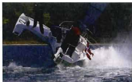
I hård vind kan DF 28 gå på hækken, som på disse billeder, når den bliver presset for meget på kurser fra bidevind til foran-for-tværs. Man undgår det ved at sejle med mere åbent storsejl eller rebe yderligere.
