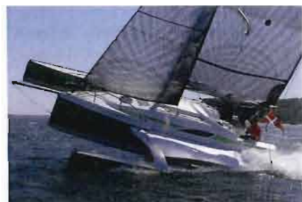
I hård vind kan DF 28 gå på hækken, som på disse billeder, når den bliver presset for meget på kurser fra bidevind til foran-for-tværs. Man undgår det ved at sejle med mere åbent storsejl eller rebe yderligere.
