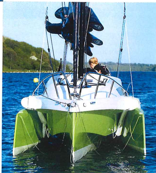
Der kun få minutter at folde båden sammen over skødespillene. Bemærk, at båden krænger lidt, når kun det rog er foldet ind. Båden bliver meget stabil, når begge sideskrog er foldet ind, fordi båden i høj grad flyder på rogene i foldet tilstand.
