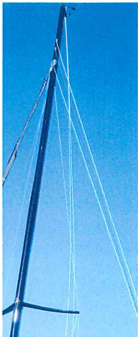
ulfibermasten fra danske Vision er med høj finish. Bemærk, hvordan salingshornene buer agterover. Så kan masten drejes mere efter vind og kurs uden at genere fokken.
