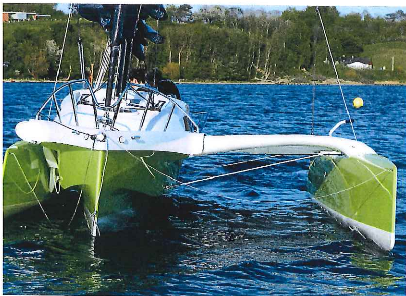
Der kun få minutter at folde båden sammen over skødespillene. Bemærk, at båden krænger lidt, når kun det rog er foldet ind. Båden bliver meget stabil, når begge sideskrog er foldet ind, fordi båden i høj grad flyder på rogene i foldet tilstand.
