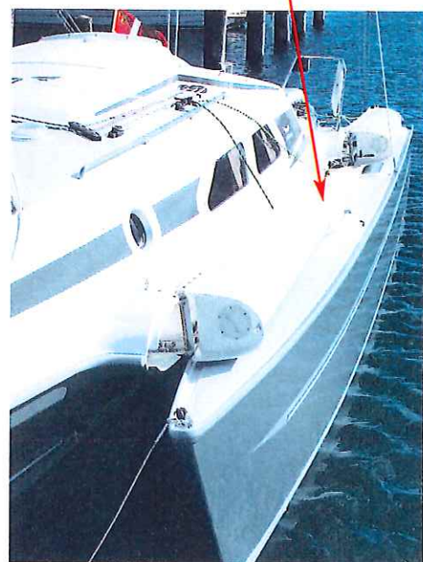
Ved hjælp af et yderst solidt og veludviklet system af hængsler på skroget og drejeskiver på pontonerne kan båden foldes sammen til kun 3,1 meter på under ét minut. Når diverse støttestag er løsnet, foldes båden med ét hal over skødespillet.
