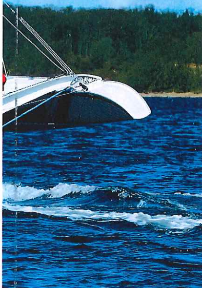
(1) Nur 3,20 Meter im Hafen – das passt überall, vor allem mit aufgeholtem Schwert ist ein Platz nahezu garantiert. Aber: Hafenanöver wollen geübt werden. (2) Saubere Arbeit: Die Verbindung der Beams mit dem Rumpf ist grundsolides Handwerk. (3) Der Rumpf wird im Sandwich-Verfahren mit Divinycell-Schaumkern gefertigt, sehr sorgfältige Verarbeitung
