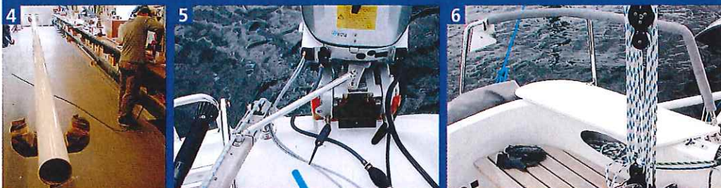
(4) Jeder Dragonfly Extreme bekommt in der Standard-Ausführung eine Kohlefaser-Mast. Die Rohre stammen aus Industriefertigung (Windmühlen) und sind nicht profiliert, damit sie im Hafen wenig Windwiderstand bieten. (5) Eine Verbindung zwischen Außenborder und Pinne vereinfacht das Steuern. (6) Herunterklappbarer Cockpit-Sitz: bequem und praktisch
