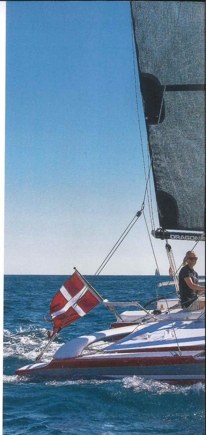
ROTTERER: Båten som ble seilt var blitt oppgårdert med en høy karbonfibermast. Ved å justere mastens rotasjon justeres også dybden i storseilet.
